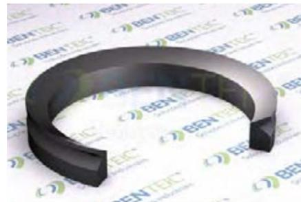
Vedadores em formato de anel com seção definida. São aplicados em movimentos rotativos de altas velocidades e baixas pressões. Descrição Raspagem: o Vring é fixado no eixo sob pressão e por conta disso gira solidário ou eixo, proporciona excelente eficiência.
